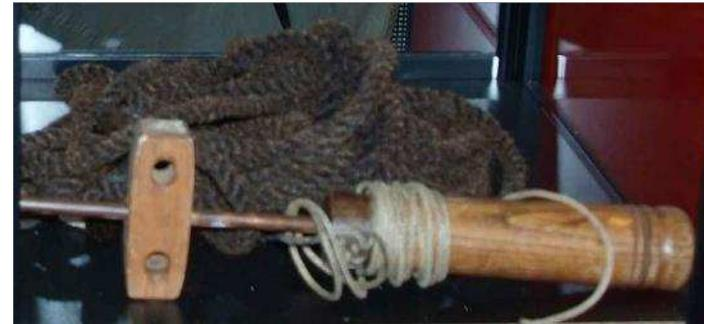
système permettant de passer les cordages dans la coque du bateau et la voile
